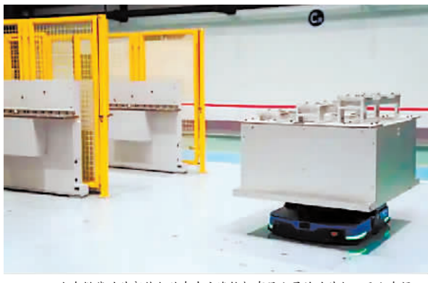
AGV小车搭载叶片部件行驶在东方汽轮机有限公司的叶片加工无人车间。
