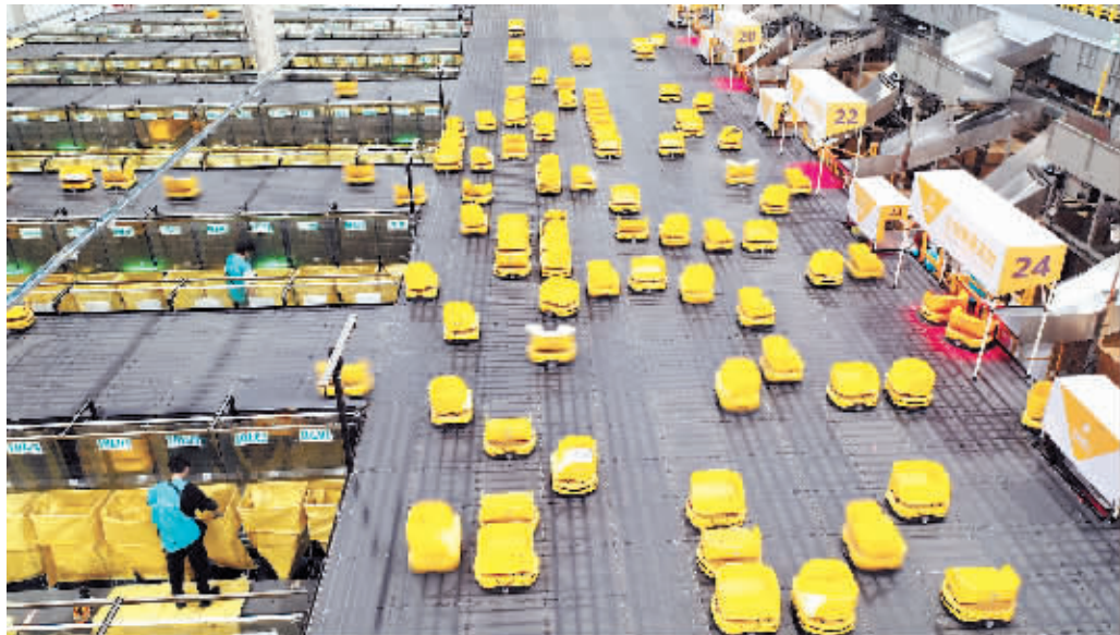
在浙江省一物流中心,800余台分拣“小黄人”机器人在精准配送各类服饰。 新华社发
