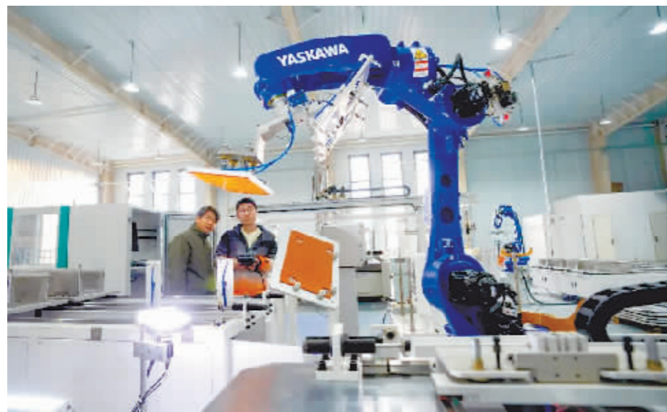
融信达低碳智慧园区项目生产厂房内，技术人员正在调试电堆自动化生产线设备。
