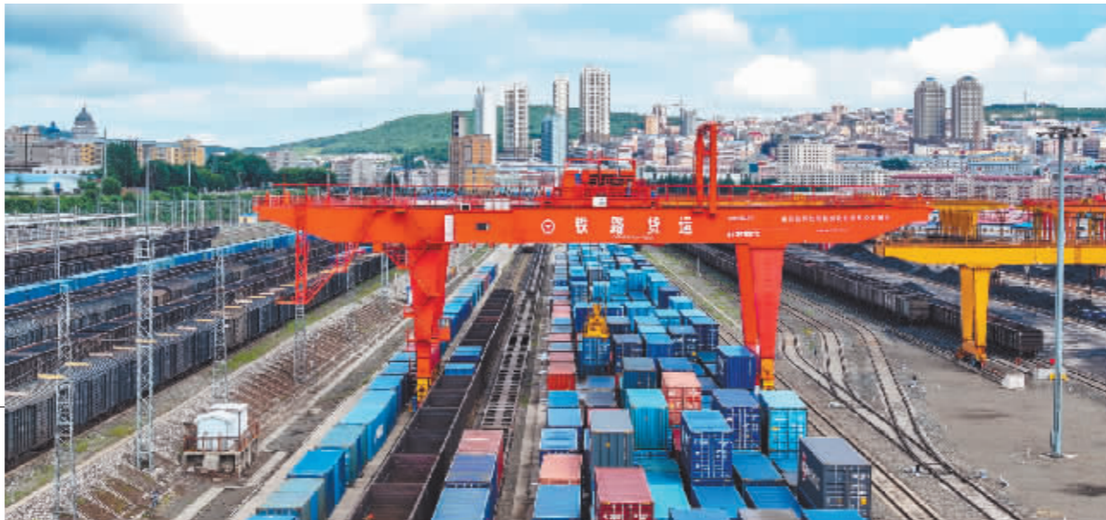
在黑龙江绥芬河铁路口岸集装箱换装场,集装箱专用龙门吊对回程中欧班列进行换装。 新华社发
