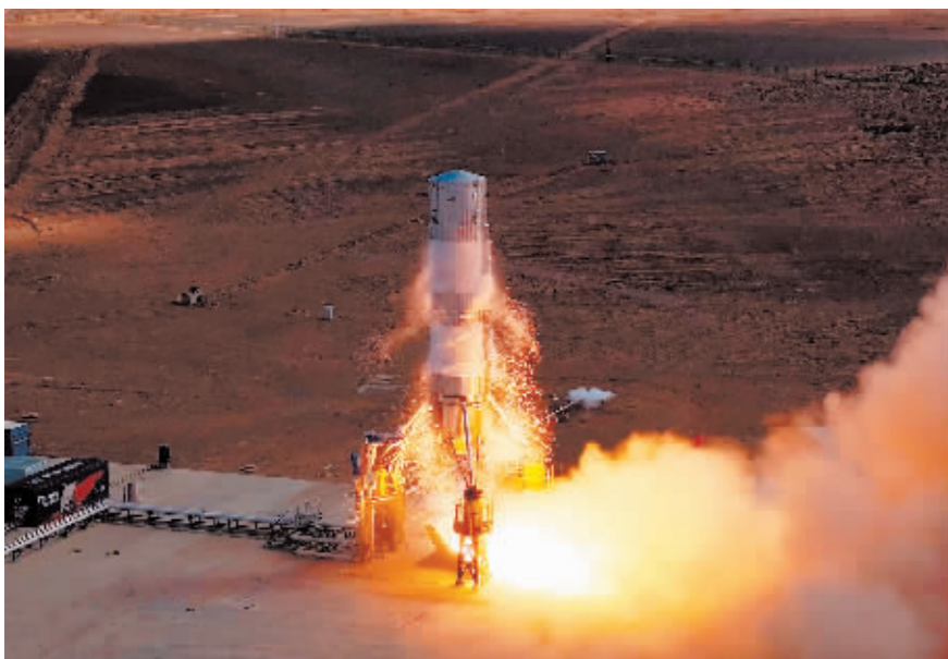
朱雀三号VTVL-1可重复使用垂直起降回收试验箭。(蓝箭航天供图)
