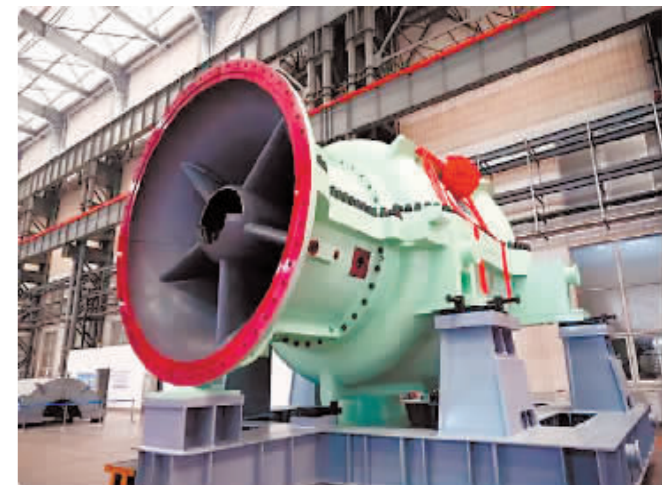
青海格尔木60MW液态空气储能示范项目配套离心压缩机。
