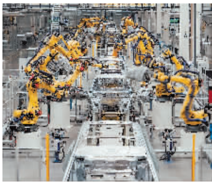
在重庆市两江新区拍摄的赛力斯汽车超级工厂焊装车间生产线。
