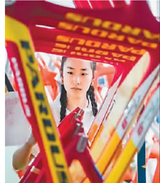
在山东泰山瑞豹复合材料有限公司生产车间，工人在检测碳纤维自行车架。泰山体育为本届奥运会的摔跤、自行车、跆拳道、体操、田径等比赛提供器材。
