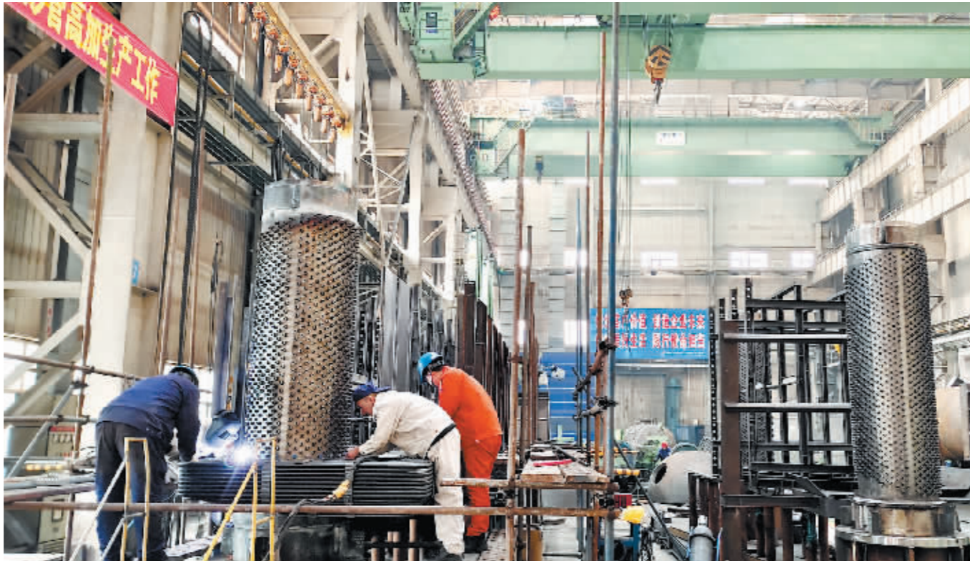
哈电锅炉项目蛇形管高压加热器制造现场。
