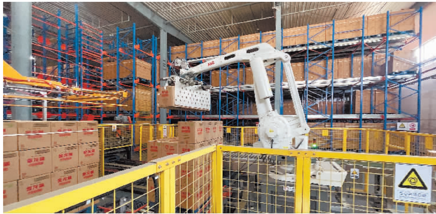
益海嘉里(哈尔滨)高度集成的全自动仓储中的智能码垛机械臂。
