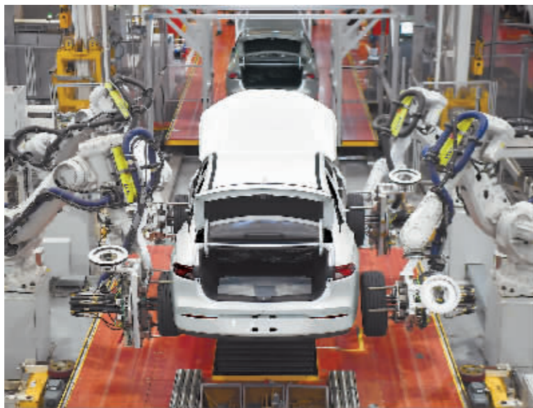
广州广汽埃安新能源汽车的全自动化轮胎安装工作站。新华社发
