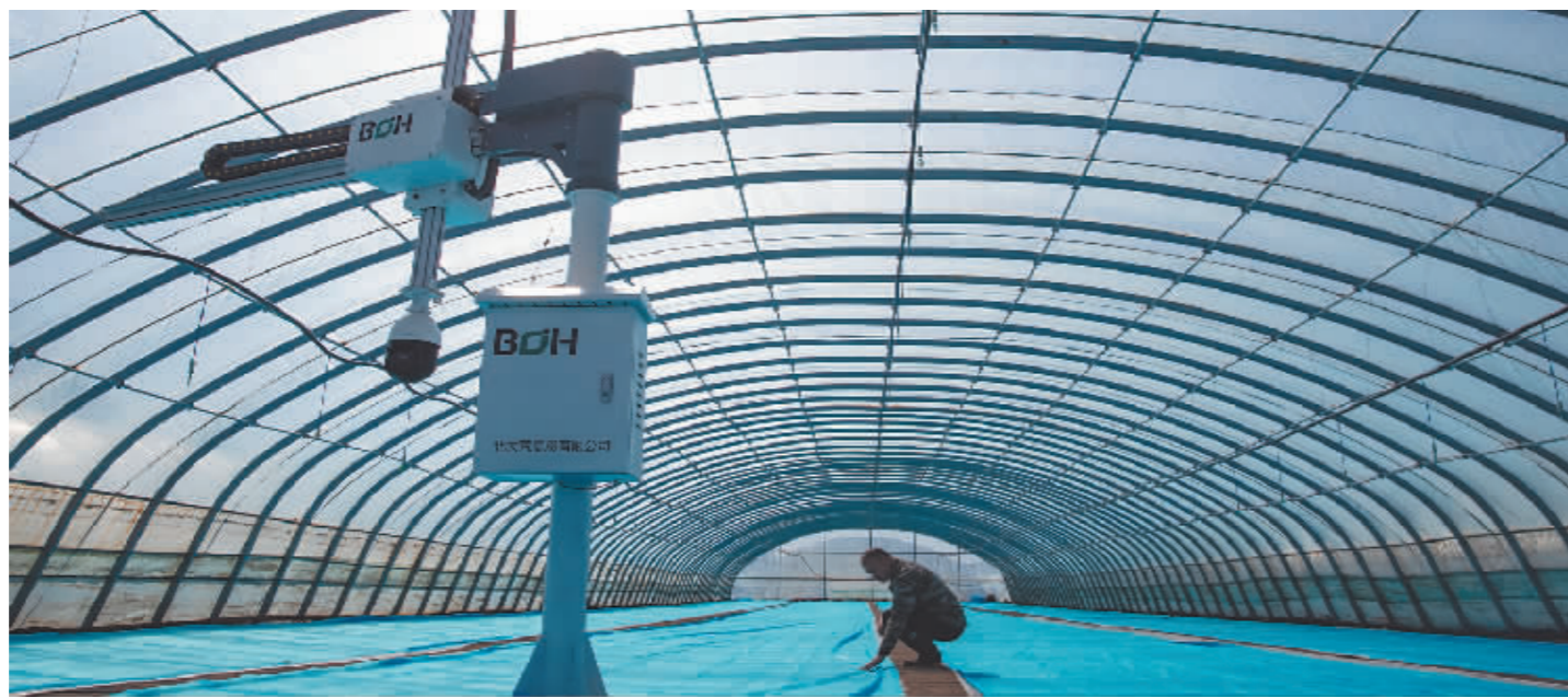
2024年4月8日在北大荒集团同家岗农场有限公司农业现代化示范区拍摄的视觉传感叶龄诊断仪。 新华社发
