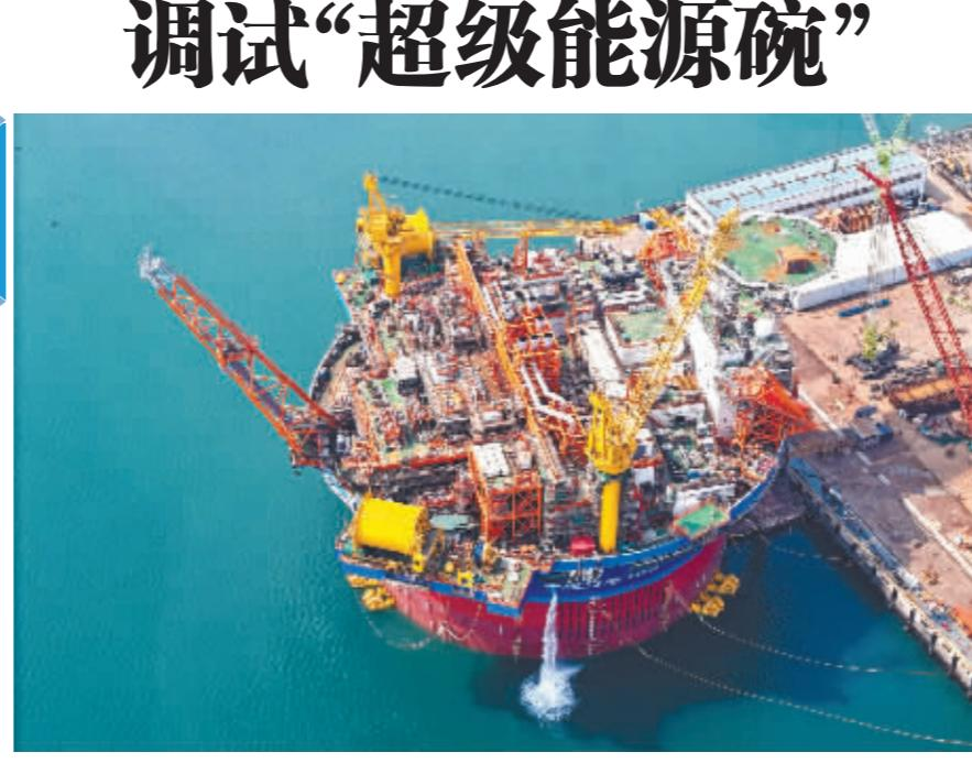
4月7日，由我国自主设计建造的亚洲首艘圆筒型“海上油气加工厂”——“海洋石油122”浮式生产储卸油装置(FPSO)，在海油工程青岛场地进行海上倾斜试验及调试，为项目年内投产奠定基础。海洋石油122”被称为“超级能源碗”，最大排水量10万吨，最大储油量6万吨，可连续在海上运行15年不回坞。
