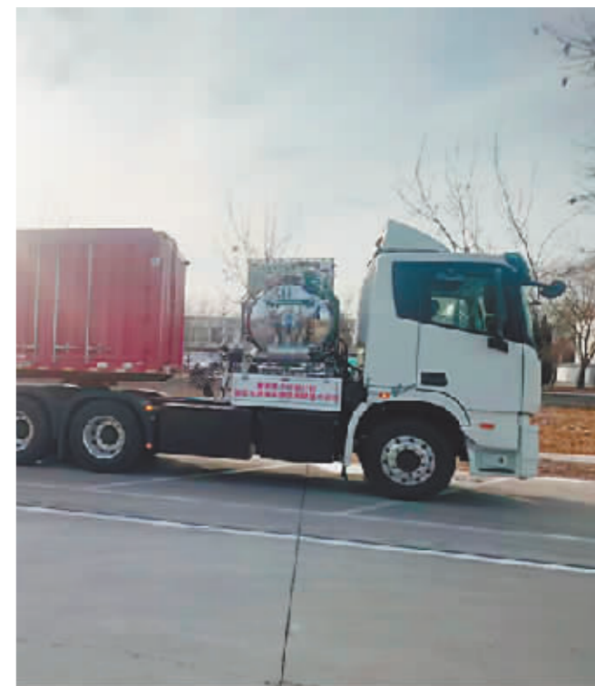
使用车载液氢储供系统的重型卡车。(航天科技集团第六研究院供图)
