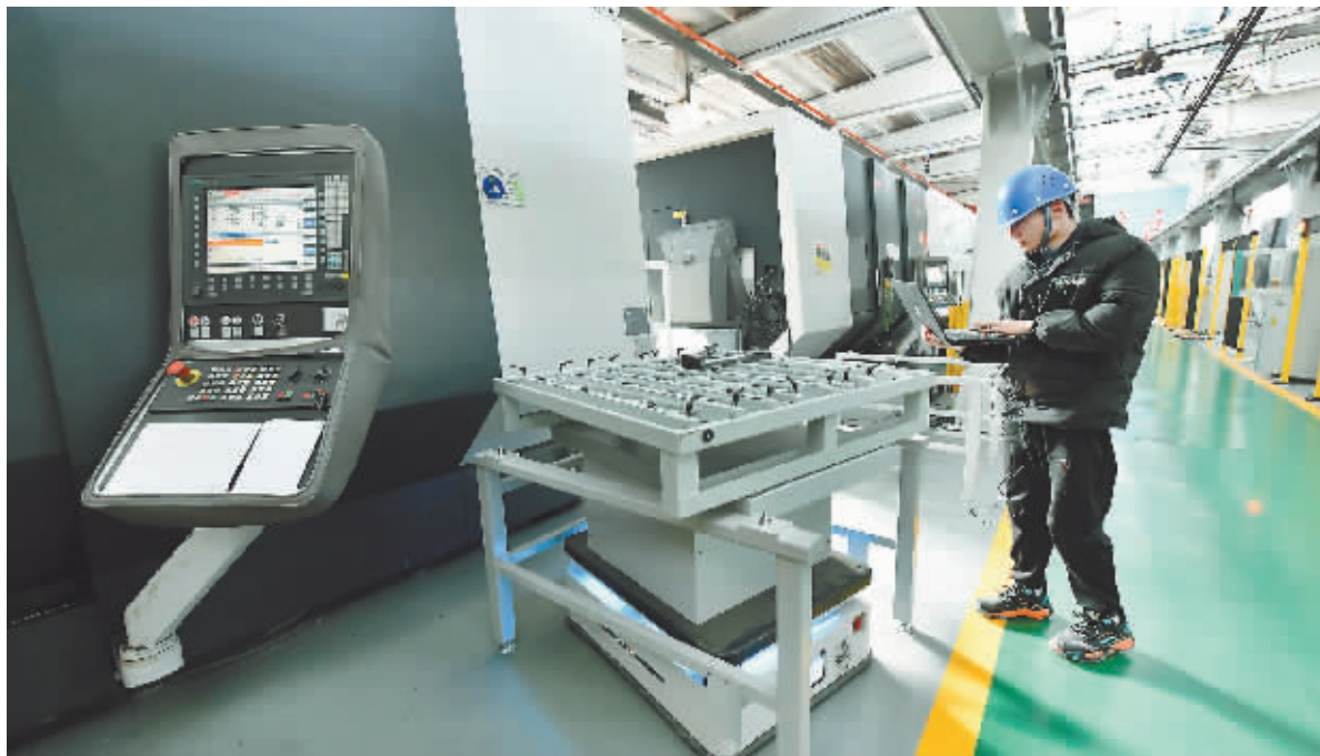
在哈电集团哈尔滨汽轮机厂有限责任公司叶片加工智能化工厂,工作人员在对中小叶片数字化生产线上的运输机器人进行测试。
