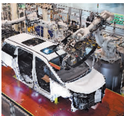
在广州一家汽车工厂总装车间内,机器人手臂在安装汽车玻璃。新华社发
