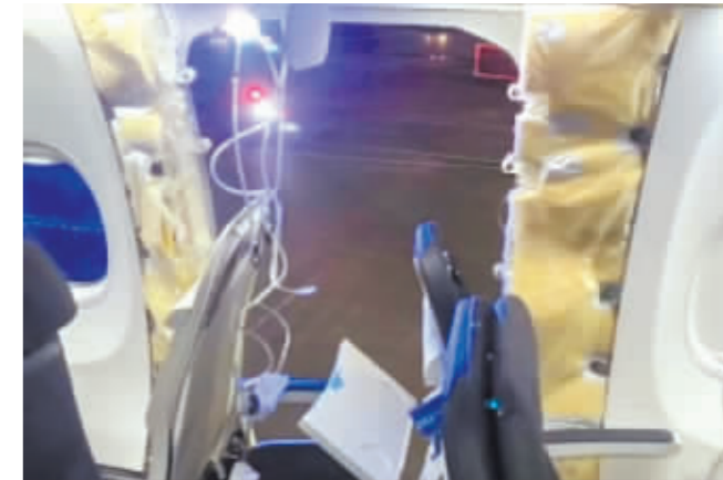
发生事故的波音737 MAX 9型客机上乘客座位旁的机舱侧面出现一处破损。
