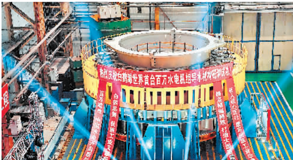
哈电集团设计制造的世界单机容量最大的白鹤滩1000兆瓦全空冷冷水轮发电机组。(本报资料片)
