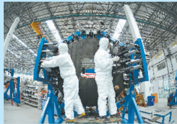
工程人员在位于沈阳的中航沈飞民用飞机有限责任公司厂区内进行C919后机身段79框的施工。
