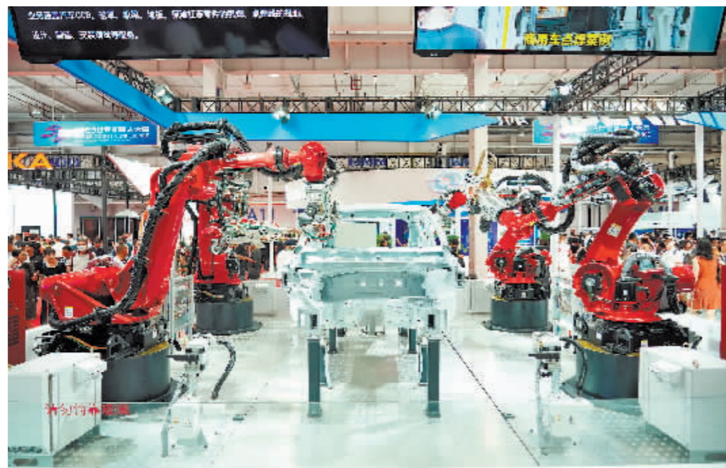
在2023世界机器人大会现场拍摄的白车身点焊机器人工作站。
