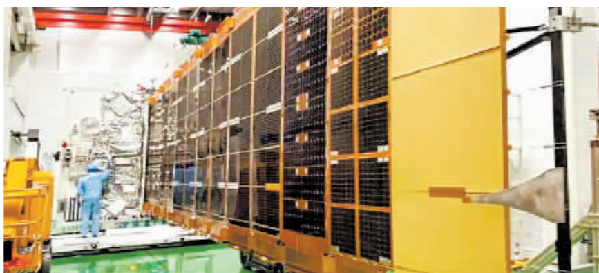
银河航天灵犀03星柔性太阳翼展开状态。
