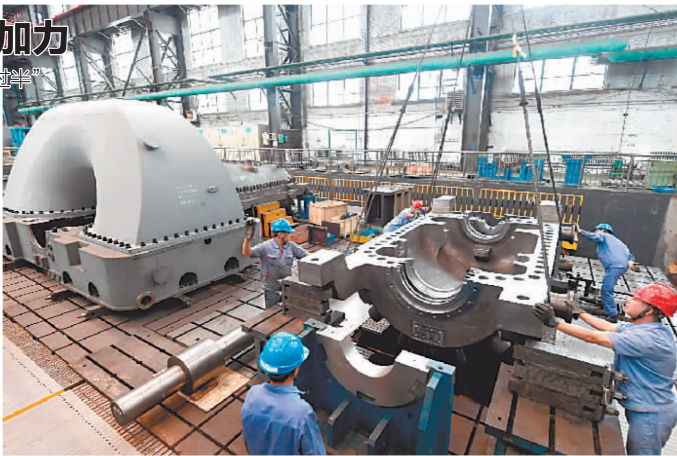
哈电汽轮机重装分厂总装钳工进行装配作业。
