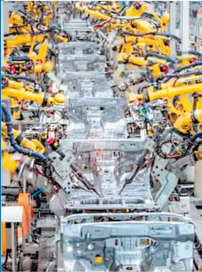
在长城汽车重庆永川生产基地,智能化焊接机器人在进行焊接作业。
