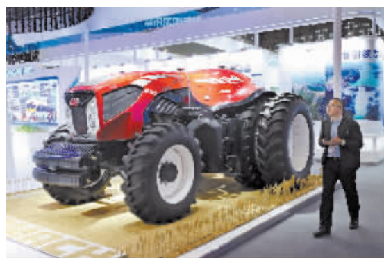
参观者从一辆东方红 LF2204 无人驾驶大马力拖拉机旁走过。
