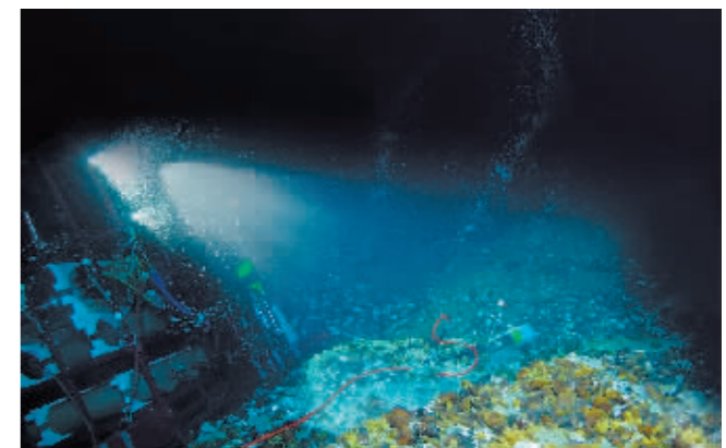
图为深海坐底长期观测系统在我国南海冷泉开展原位观测。 央视网发
