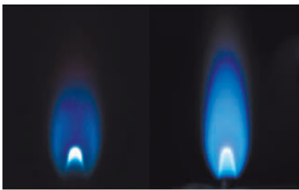
空间站燃烧科学实验柜甲烷燃烧图像(左)与地面同种工况甲烷燃烧图像(右)。
