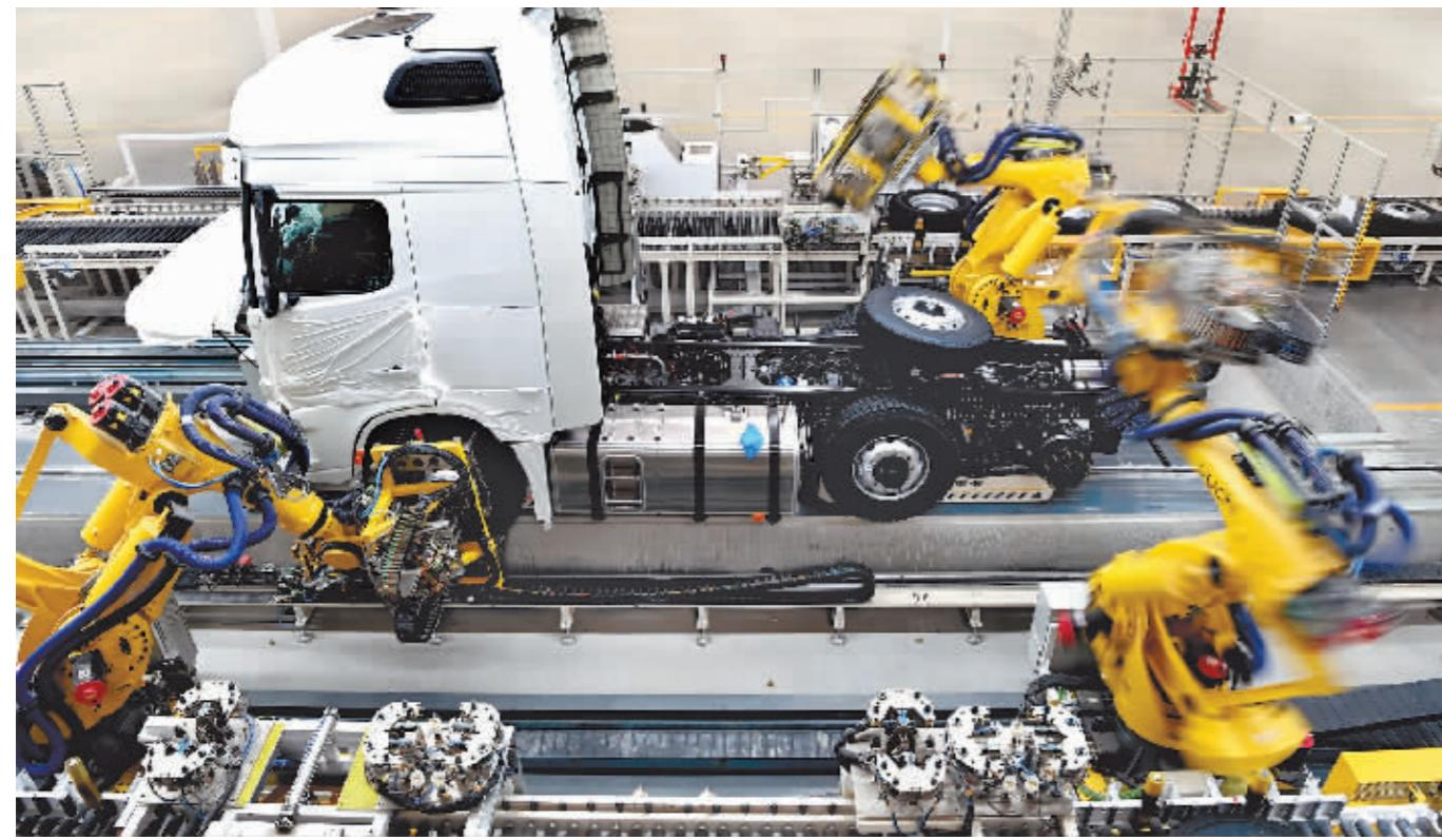
图为在陕西汽车控股集团有限公司，一辆重卡在汽车总装生产线上自动化装配拧紧无人工作站进行装配。新华社发
