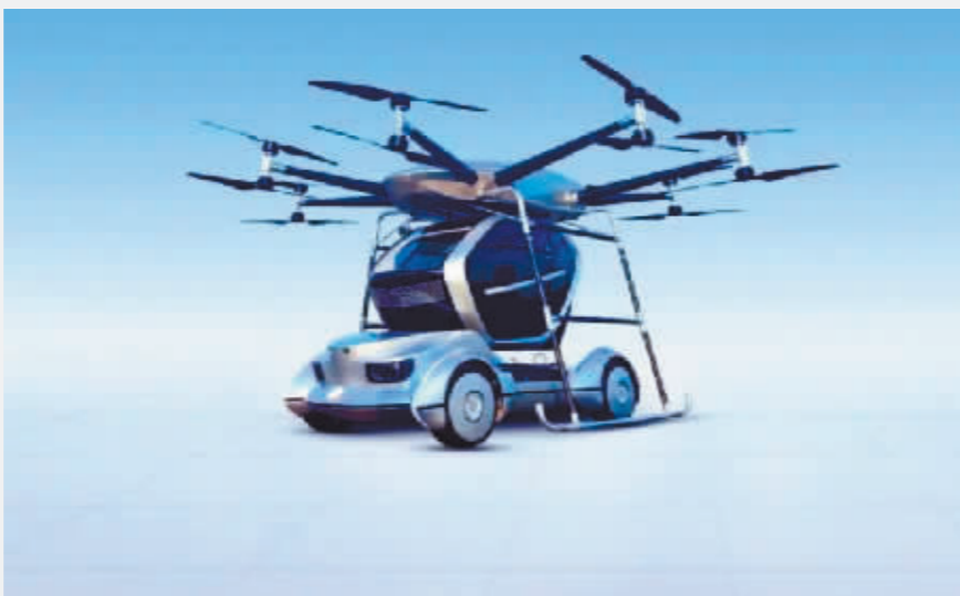
载人级两座智能分体式飞行汽车工程样车。
