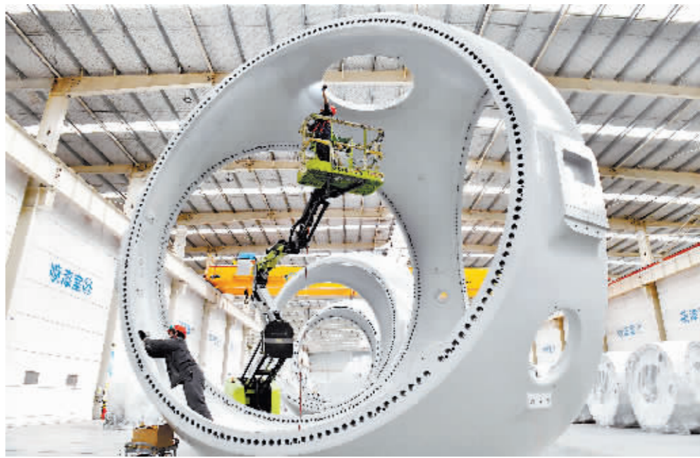
▲ 在山东省惠民县风电装备产业基地涂装车间,工作人员对风电轮毂进行涂装。 ▲ 观众在“奋进新时代”主题成就展中央综合展区拍摄中国经济“奇迹号”巨轮模型。
