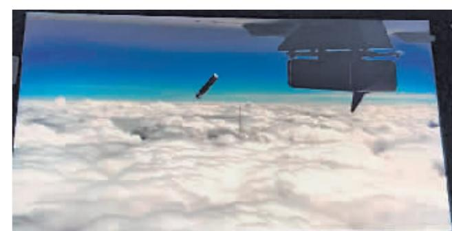
此次试验的投放监控实况图,图中圆柱体为下投式探空仪。
