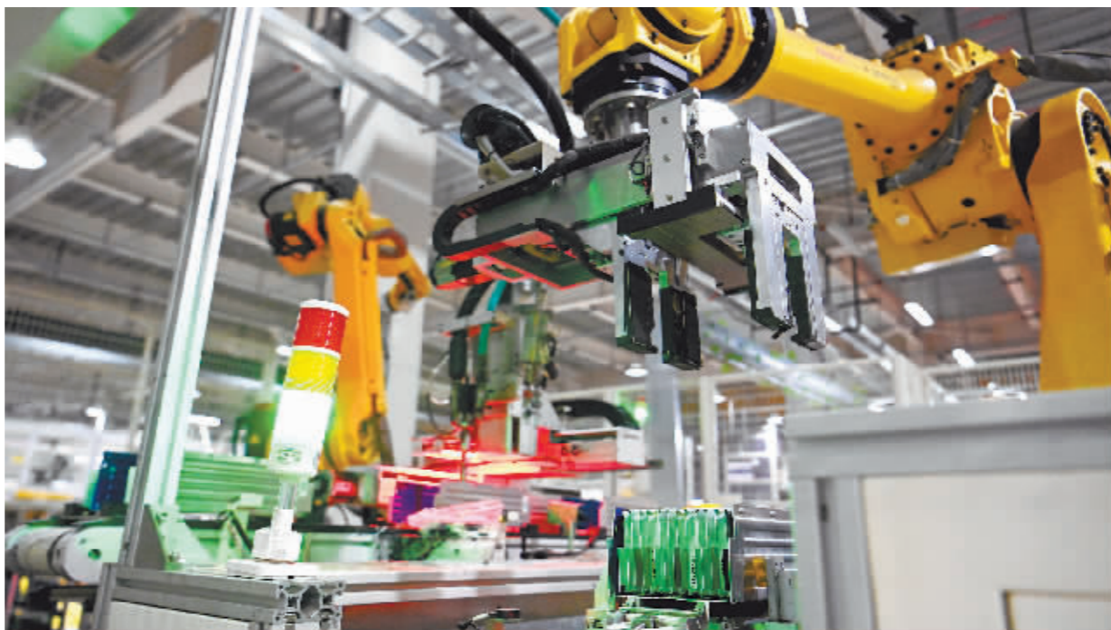
在天津荣盛盟固利新能源科技有限公司模组车间,工业机器人在生产线上搬运动力电池模组。新华社发
