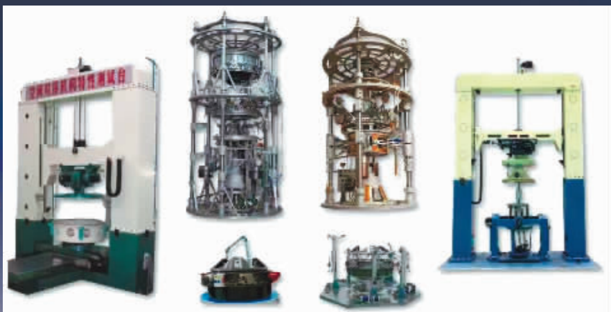
空间对接机构地面测试系列装备。
