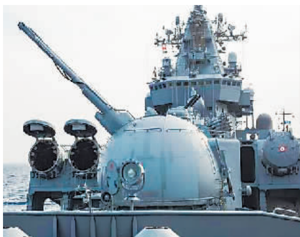
图为2015年12月17日在叙利亚拉塔基亚省塔尔图斯港附近拍摄的“莫斯科”号巡洋舰“AK-130”多用途双管舰炮和“堡垒”导弹发射装置。
