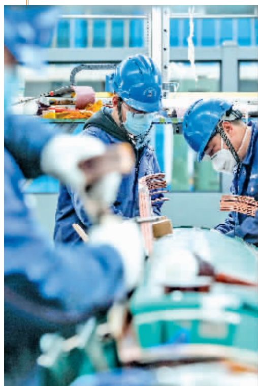
上图:在哈电集团哈尔滨电机厂有限责任公司的焊接生产车间里,焊工孙凤海正操控埋弧自动焊接设备,对越南富新II项目贯流式水轮发电机转子磁轭圈进行组合焊接。为了保证焊接质量,工件在焊接过程中要始终保持100℃以上的温度,焊工每天要在高温中作业。
