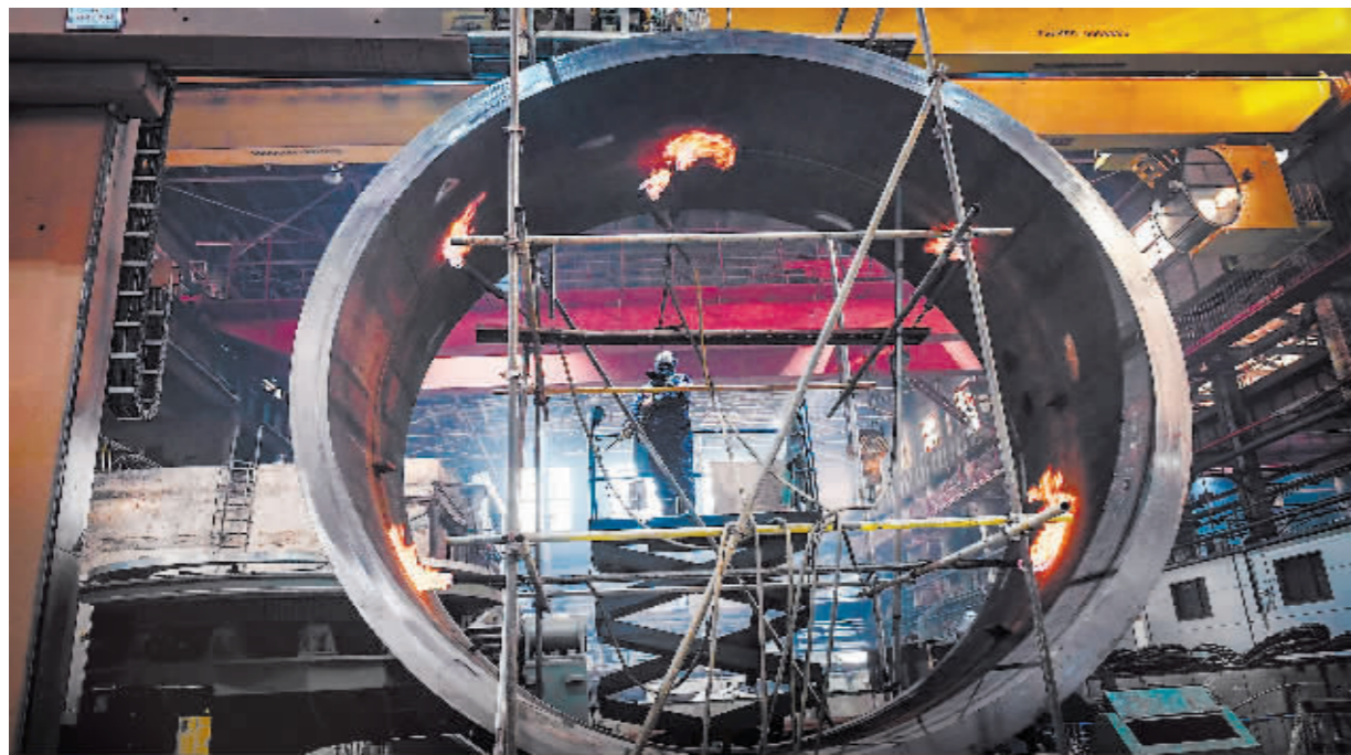
上图:在哈电集团哈尔滨电机厂有限责任公司的焊接生产车间里,焊工孙凤海正操控埋弧自动焊接设备,对越南富新II项目贯流式水轮发电机转子磁轭圈进行组合焊接。为了保证焊接质量,工件在焊接过程中要始终保持100℃以上的温度,焊工每天要在高温中作业。
