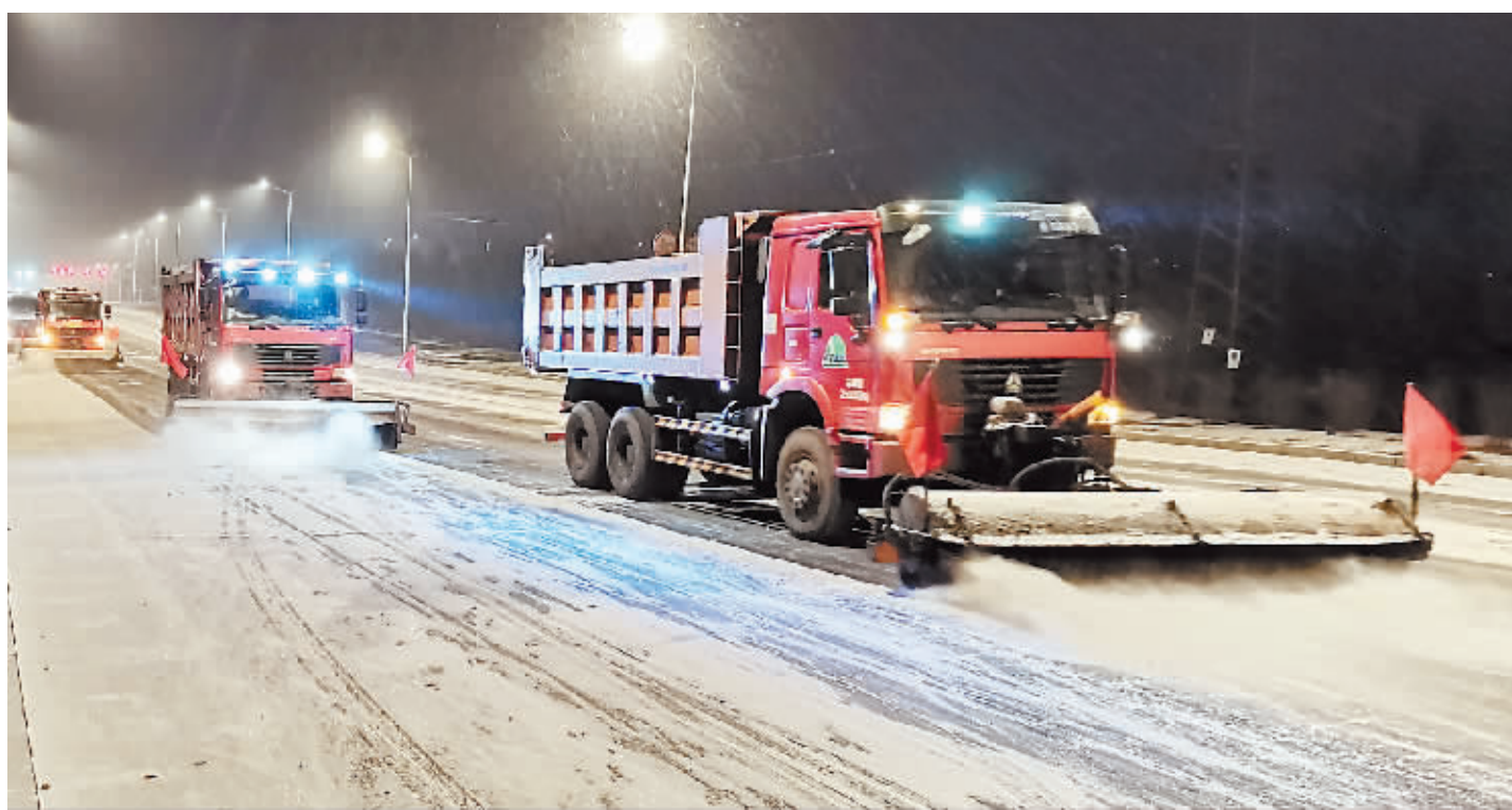
清冰雪机械对道路进行循环扫刷作业。
