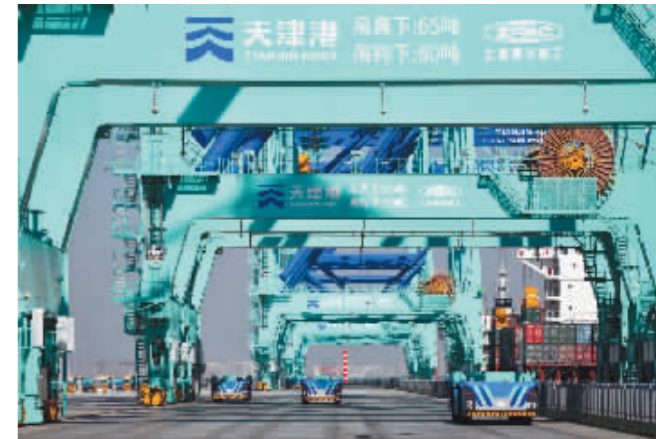
智能水平运输机器人在码头行驶。
