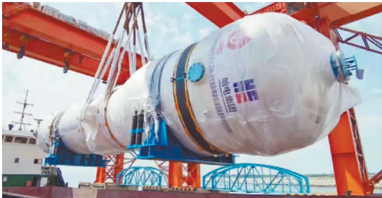
蒸汽发生器单台设备总重385吨,设计寿命60年。
